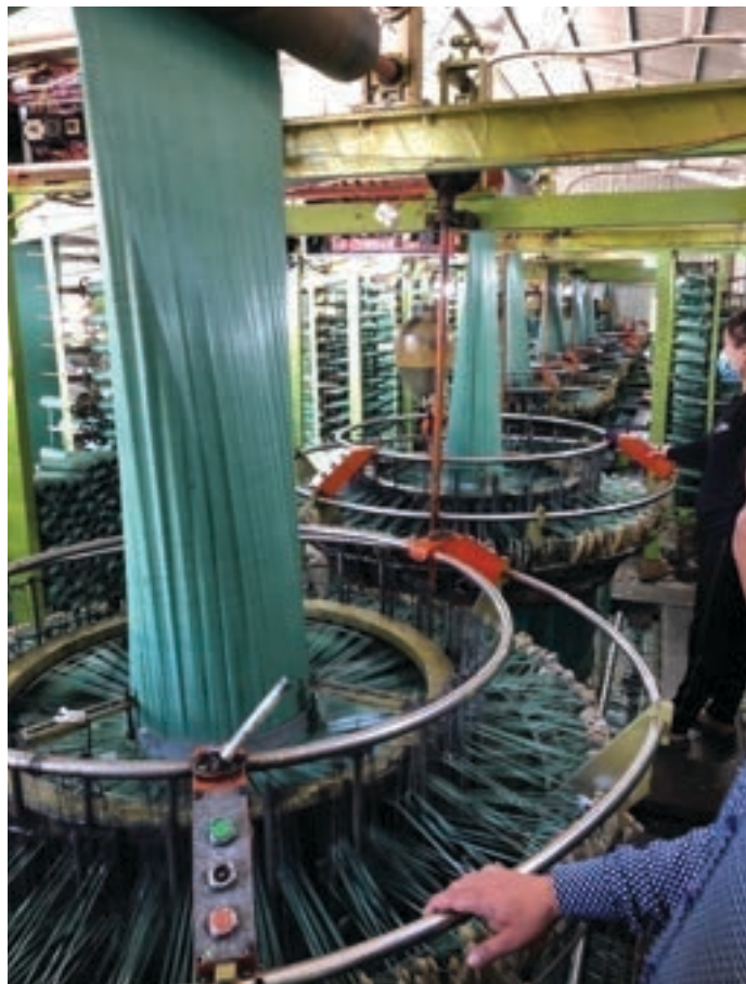
ເຄື່ອງຈັກຕໍາເປົາ ເຊິ່ງຈະຕໍາເສັ້ນປລາສຕິກໃຫ້ເປັນຮູບຊົງກະບອກ ແລະ ນໍາໄປຕັດເພື່ອຫຍິບເປັນເປົາ
